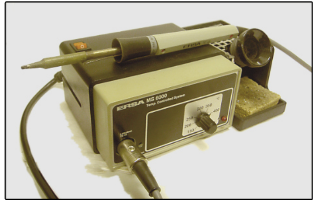
Temperaturreglerad lödstation. Lödstation av märket Ersa. Stationen har variabel temperaturkontroll. Även andra märken i olika prislägen finns (Stannol, Weller etc.).
