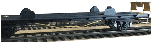
Nytt spännstag monterat. Monterade plattform och fotsteg syns på bilden.
