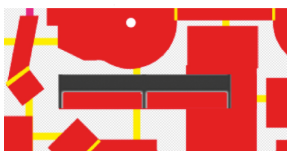
Mall för stänkskärmar. Dela T-stapeln i två remsor och löd på stödtrådar.
