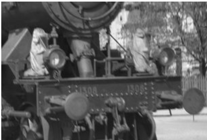
De gasdrivna lyktorna står på sin ursprungliga plats. Domkrafterna står vid sidorna omsvept en av skyddande presenning.
