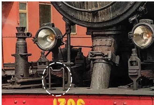
De elektriska lyktorna har placerats längre bak och något högre. Domkrafterna utan klädnad. Det ensamma fotsteget på gångbordet.
