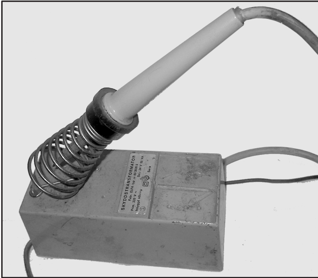
Standard lödstation, 30 W (äldre modell) med fast temperaturkontroll.
