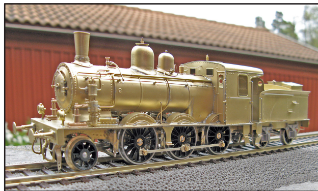
H0-modell av Lok litt L23 nr 1714 (f.d. SWB F3a nr 40). Byggare Sture Holmberg. Modellen är blästrad med aluminiumoxid och avslutningsvis med glaspärlor.
