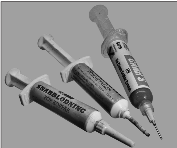
Tennpasta (62 % Sn, 36 % Pb, 2 % Ag) av Carr's tillverkning. De andra sprutorna, RAND från Henrik Wrethman, innehåller tenn med lite silver. Smältpunkt 220°C. Järnhandelsprodukter.
