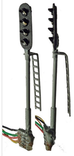
Fig.1 Modern fyrskenssignal bestyckad med dioder på kretskort
