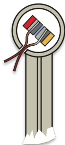
Fig. 9 Löd ihop dioderna enligt texten med två eller tre ledare. Peta in diodern enligt figuren och säkra läge med lite lim.
