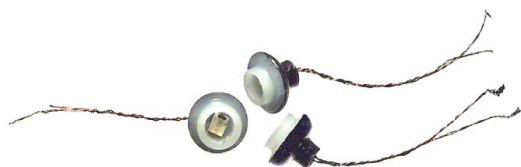
Fig. 4. Lamporna är svarvade i Delrin. Dioderna som använts är medelstora (2x1,25mm)
