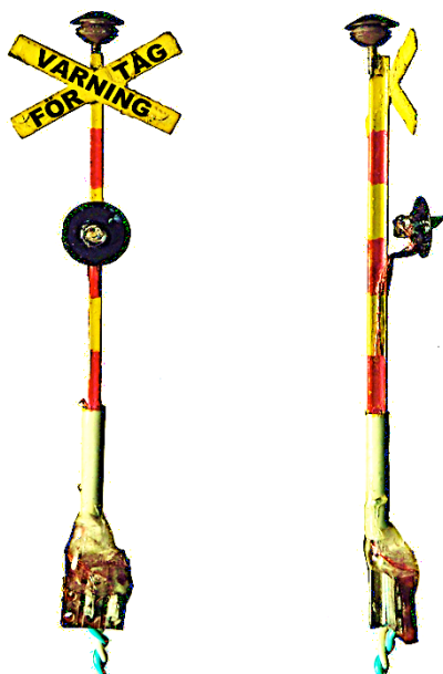
Fig. 4. Vägskyddsmärke där diodens tunna ledningar är nerförda längs stolpen till en bit kretskort där de grövre matningskablarna kan lötas in
